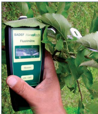
Նկար 73. Տերուններում հանքային սննդատարրերի վիճակի գնահատման տիպային սարք
