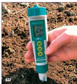
Նկար 90. Հողի թթվային ռեակցիայի (pH) որոշարկման միջոցներ՝ ա) պեհաշմետր, բ) լսկմուսի թուղթ
